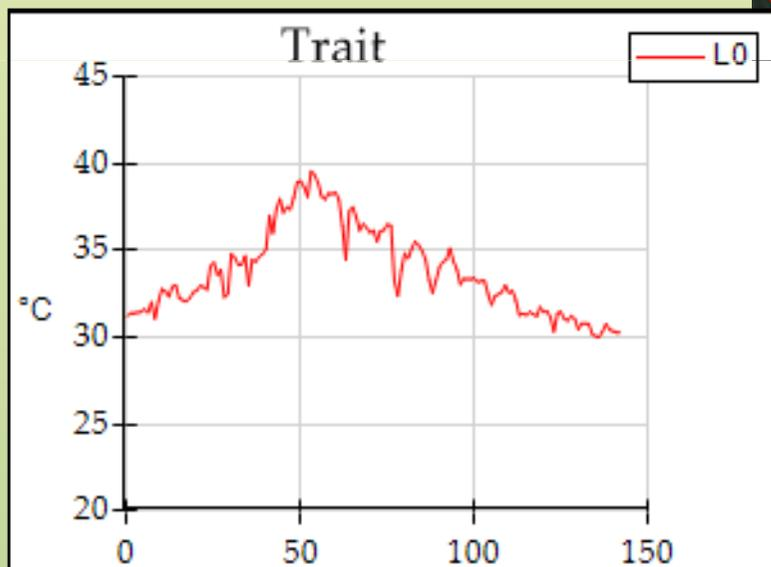
Zone sous radiant : 40°C au point central, perte de 10°C à 1m de ce point
