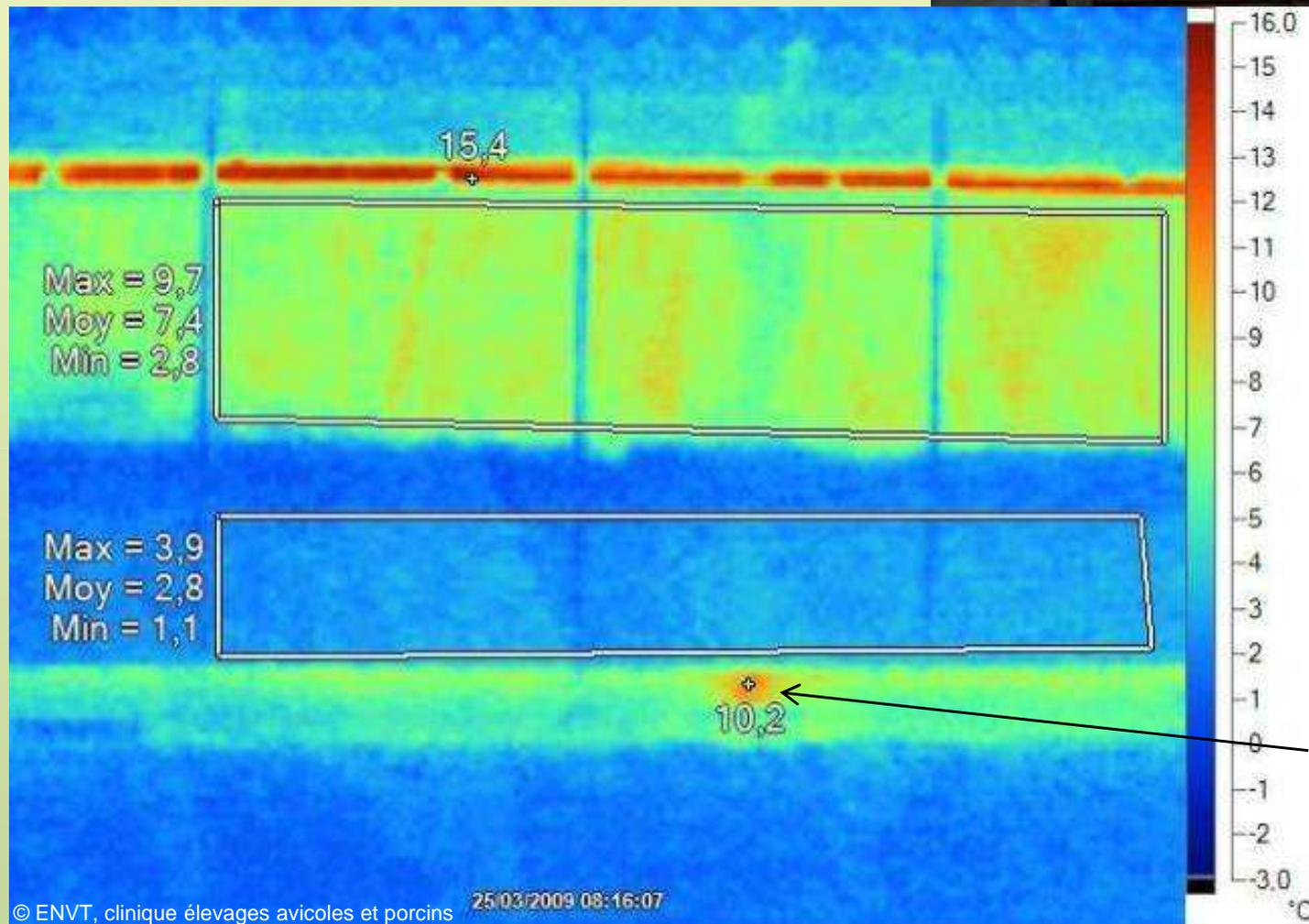
Noter la déperdition de chaleur par la poutre métallique (pont thermique)
